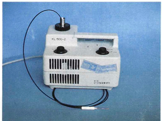
Fig 2. Fuente de Luz Fría de la casa Zeiss y Fibra Optica de cirugía de vitro y adaptador metálico especialmente diseñado.
