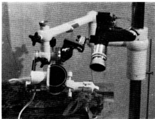
Fig. 20 Dispositivo empleado para fotografía de la sección óptica de la lámpara de hendidura.
